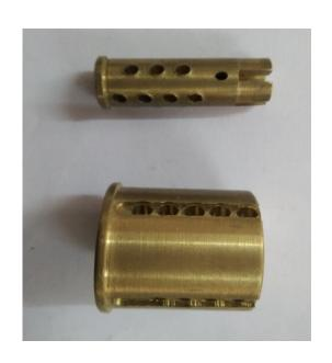
Cycle time(Output/hr.) Two components in 15 sec.(480/hr.)
